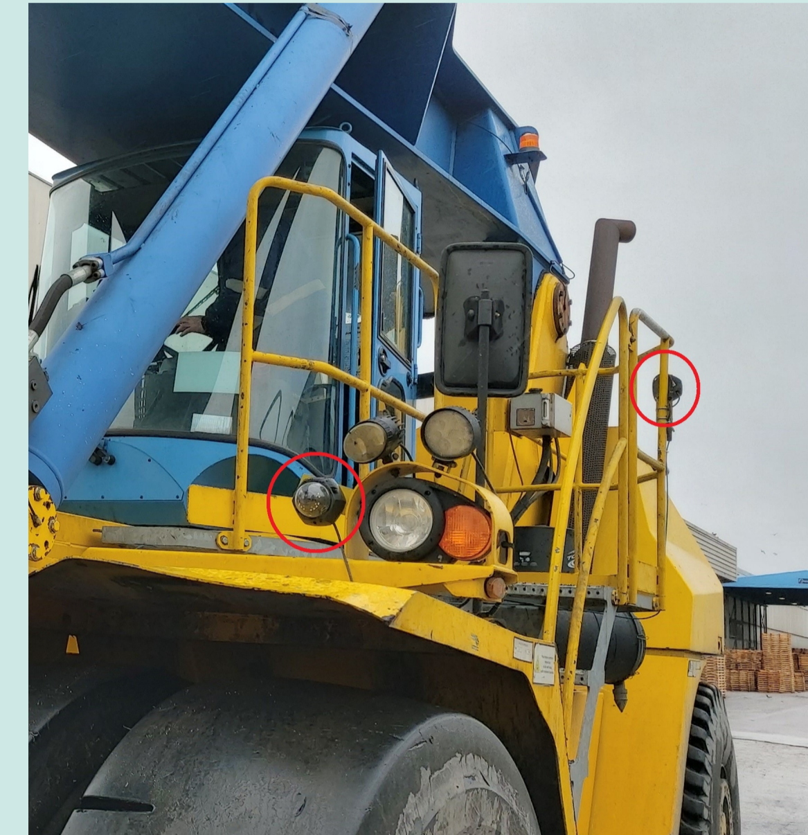
Figura 1 – Le telecamere del sistema installate su reachstacker
